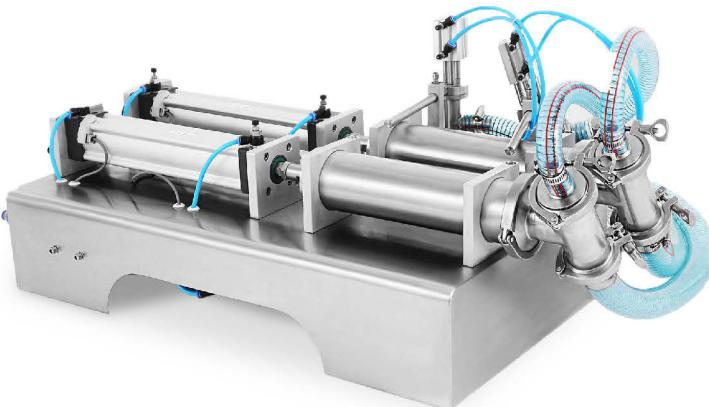
تقوم الآلة بتعبئة المواد السائلة و اللزجة بشكل نصف آلي ، يتميز هذا الموديل بأنه مزود برأسين للتعبئة مما يزيد في الإنتاجية ، وسحب المواد يكون من خلال خرطوم ممكّن ضبط الوزن المطلوب و بدقة ، تسليزم وجود لحامة بعد عملية التعبئة لاغلاق الأكياس المعبيّة . يمكن الاطلاع على اللحامات و أنواعها في القسم الخاص بها في الكاتلوج .
