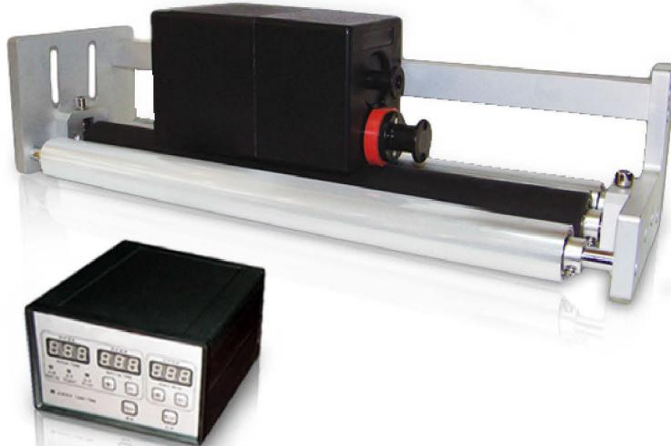
ثبتت هذه الطابعة الآلية على آلات التعبئة الرأسية و الأفقية (فلو باك) تستخدم لطباعة التاريخ و الوزن و السعر . تتميز هذه الطابعة برأس دوار لذلك الطابعة تقوم بالطباعة أثناء مرور الورق دون الحاجة للتوقف.
